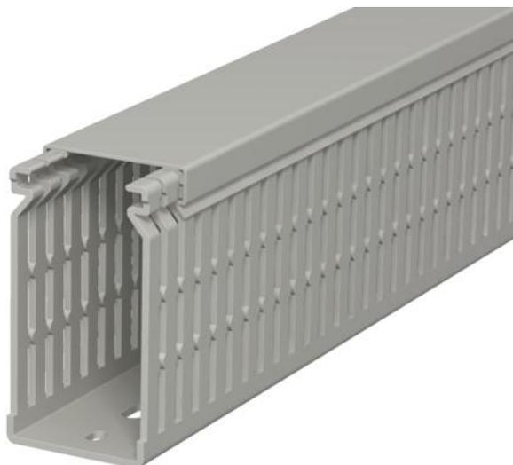
Verdrahtungskanal inkl. Oberteil und Bodenlochung zur waagerechten und senkrechten Verlegung elektrischer Kabel und Leitungen im Schaltschrank. Ausführung als metrischer Kanal. Das Nennmaß der Systemgröße entspricht dem Innenmaß der Kanäle. Das Ausbrechen der Stege erfolgt werkzeuglos. Bodenbündiges Ausführen ist durch Sollbruchstellen möglich. Verjüngungen in den Seitenschlitz verhindern das Herausfallen der Leitungen. Geprüft nach DIN EN 50085-2-3. Sonderlängen auf Anfrage.
