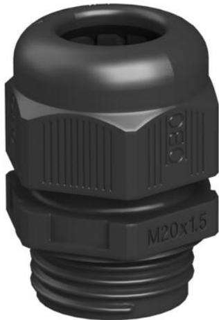
Kabelverschraubung mit metrischem Anschlussgewinde in Hutmutterbauart, für Kabelabzweiggkästen, Gehäuse, Verteilerkästen im privaten und industriellen Bereich. Mit Zugentlastung und integrierter Dichtlippe, geprüft nach DIN EN 62444. Schutzklasse IP68. Einsetzbar von -20°C bis +65°C.
