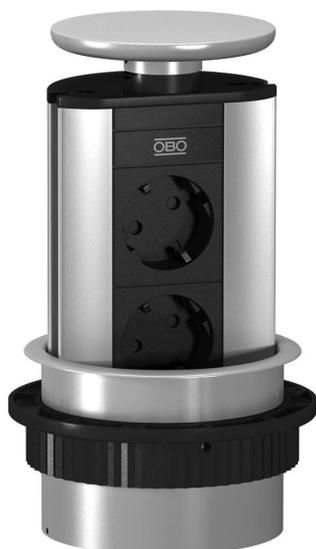
Versenkbare Deskbox mit Anschlusskabel, für den festen Einbau in eine Tischplatte, Befestigungsmanschette aus Kunststoff, passend lackiert in Deckelfarben. Die Montage erfolgt über eine Bohrung ( $\varnothing 102$  mm) in der Tischplatte. Bestückung: - zwei schwarze Schutzkontakt-Steckdosen in 60°-Steckrichtung, inkl. 3,0 m Netzkabel mit Winkelstecker CEE 7/7. Hinweis: Einsetzbar in Tischplatten bis maximal 50 mm Stärke.
