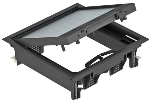
Geräteinsatz mit Rastschieber für bis zu 6 Modul 45-Einzelgeräte in 2 Universalträger UT3, Einsatz in Kanalsystemen und Systemböden im Innenbereich. Bodenbelagausparung im Klappdeckel voreingestellt auf 5 mm, bei Bedarf auch einstellbar auf 3, 8 oder 10 mm. Bis zu 4 Installationsgeräte mit 50er-Zentralplatte einsetzbar.
