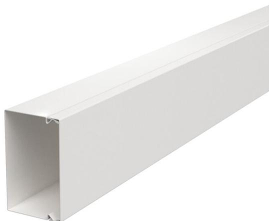
Kanaloberteil und -unterteil mit Bodenlochung. Der Potentialausgleich ist ohne weitere Hilfsmittel zwischen Unter- und Oberteil gewährleistet. Der LKM Leitungsführungskanal Typ LKM 60100 ist als Verlegesystem für Funktionserhalt nach DIN 4102 Teil 12 geprüft. Bitte beachten Sie die im Bereich BSS Brand-schutz-Systeme geprüften Kabeltypen!
