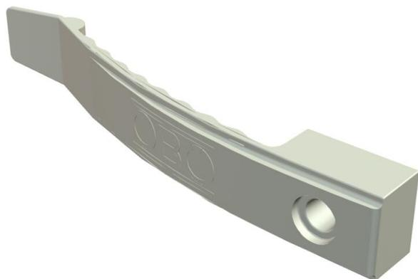
Standardausführung für allgemeine Anwendung, wie z. B. Zwischendecken und Zwischenwand-Installation. Klemmhöhe 9 mm - mit Distanzstück 13 mm. Befestigungsloch 6 mm Ø.
