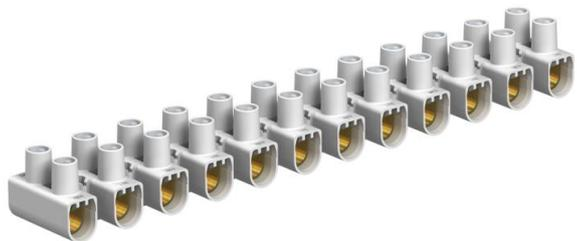
Geprüft nach EN 60998. Klemmen Stahl, Schrauben Stahl, galvanisch verzinkt, 12-polige, in Einzelklemmen abtrennbare Leisten durch "twist'n'pull". Schrauben hochgedreht, unverlierbar. Max. zulässige Umgebungstemperatur gemäß EN 60998: -5 bis +80 °C. Nennquerschnitt 16 + mm<sup>2</sup> Nennspannung 450 V Nennstrom 76 A Max. klemmbar je Seite: 16 mm<sup>2</sup> eindrätig oder 10 mm<sup>2</sup> mehrdrätig bzw. 6 mm<sup>2</sup> flexibel.
