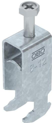
Bügel­schelle mit Hammerkopf-Fuß, Metall­druckwanne mit gerundeten Kanten für Kabelschutz. Zur vertikalen und horizontalen Montage von 2 Einzelkabeln an C-Profilschiene. Für Schlitzweite 16 - 17 mm. Mit 1-gängiger Schraube an Druckwanne, universeller Sechskant-Schraubenkopf SW10, mit Schlitz und Kreuzschlitz. Geeignet für Montage im Innen- und Außenbereich. Mehrere Kabel sollten durch Doppelwannen getrennt werden. Der Einsatz einer Gegenwanne wird empfohlen.
