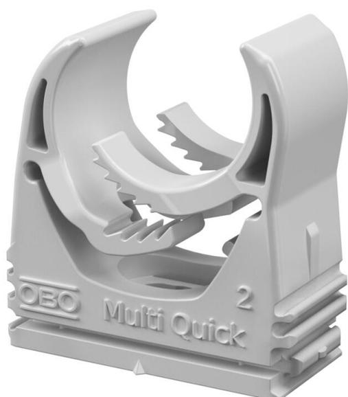
Aufputzschelle zur Aufnahme von metrischen und PG-Rohren sowie Elektroinstallationsrohr Quick-Pipe. Flexibler Spannungsbereich von mehreren Millimetern. Universelle Befestigungsmöglichkeiten an Wand und Decke und einsetzbar in Profilschiene im Innen- und geschützten Außenbereich. Werkzeuglose Rohrmontage. Aneinander reihbar auch mit OBO Quick- oder proQuick-Schelle.
