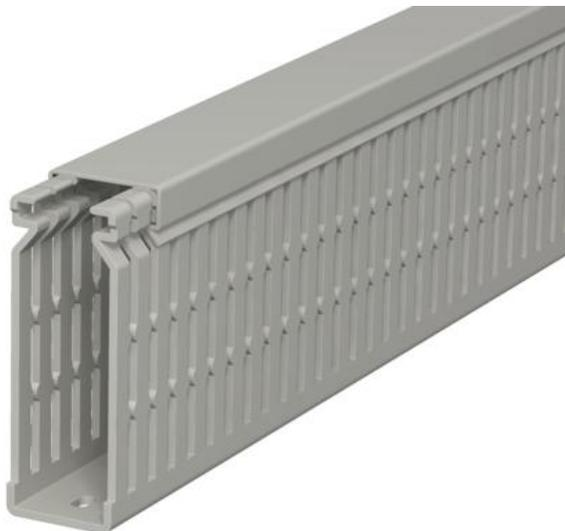
Verdrahtungskanal inkl. Oberteil und Bodenlochung zur waagerechten und senkrechten Verlegung elektrischer Kabel und Leitungen im Schaltschrank. Ausführung als metrischer Kanal. Das Nennmaß der Systemgröße entspricht dem Innenmaß der Kanäle. Das Ausbrechen der Stege erfolgt werkzeuglos. Bodenbündiges Ausführen ist durch Sollbruchstellen möglich. Verjüngungen in den Seitenschlitz verhindern das Herausfallen der Leitungen. Geprüft nach DIN EN 50085-2-3. Sonderlängen auf Anfrage.
