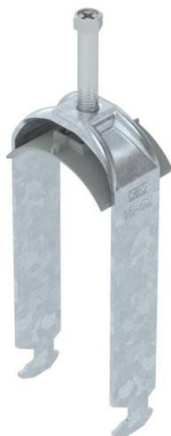
Bügelschelle mit Hammerkopf-Fuß, Kunststoffdruckwanne aus Polypropylen. Zur vertikalen und horizontalen Montage von 2 Einzelkabeln an C-Profilschiene. Für Schlitzweite 16 - 17 mm. Mit 1-gängiger Schraube an Druckwanne, universeller Sechskant-Schraubenkopf SW10, mit Schlitz und Kreuzschlitz. Geeignet für Montage im Innen- und Außenbereich. Mehrere Kabel sollten durch Doppelwannen getrennt werden. Der Einsatz einer Gegenwanne wird empfohlen.
