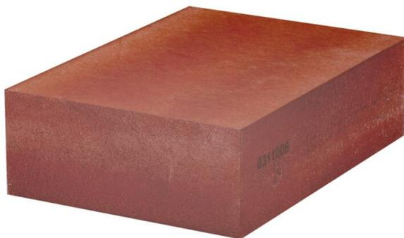
Weicher, dauerelastischer Schaublock für Kabel- und Kombiabschottungen. Längs- und Quereinbau zur Erreichung unterschiedlicher Feuerwiderstandsklassen möglich. Kombinierbar mit dem 2-Komponenten Brandschutzschaum PYRO-SIT® NG. Einsetzbar in massiven Decken und Wänden sowie in leichten Trennwänden und zugelassen für viele Installationen. Anwendung im Innenbereich. CE-gekennzeichnetes Bauprodukt gemäß ETA-15/0803 für Anwendungen mit Feuerwiderstandsdauern bis zu 120 Minuten.
