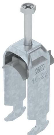
Bügel­schelle mit Hammerkopf-Fuß, Kunststoffdruckwanne aus Polypropylen. Zur vertikalen und horizontalen Montage von 2 Einzelkabeln an C-Profil­schiene. Für Schlitzweite 16 - 17 mm. Mit 1-gängiger Schraube an Druckwanne, universeller Sechskant-Schraubenkopf SW10, mit Schlitz und Kreuzschlitz. Geeignet für Montage im Innen- und Außenbereich. Mehrere Kabel sollten durch Doppelwan­nen getrennt werden. Der Einsatz einer Gegenwanne wird empfohlen.
