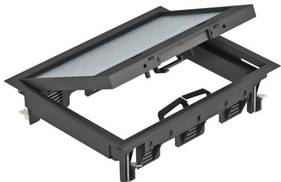
Geräteinsatz mit Rastschieber für bis zu 9 Modul 45-Einzelgeräte in 3 Universalträger UT3, Einsatz in Kanalsystemen und Systemböden im Innenbereich. Bodenbelagausparung im Klappdeckel voreingestellt auf 5 mm, bei Bedarf auch einstellbar auf 3, 8 oder 10 mm.
