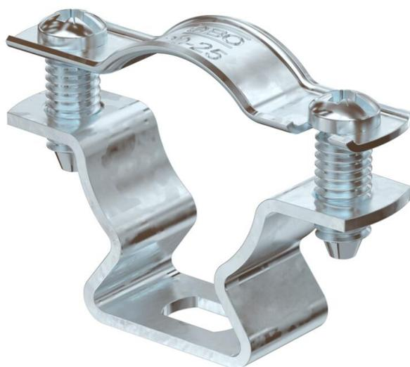
Abstandschele zur Montage von Rohren und Kabeln an Wand, Decke und Boden. Mit selbstsicherndem Oberteil. Befestigung über Langloch. Zugelassen für den Funktionserhalt nach DIN 4102 Teil 12, Funktionserhaltklassen E 30 bis E 90.
