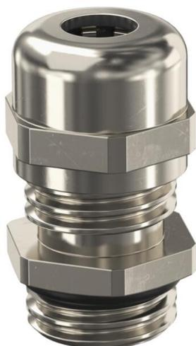
Robuste Kabelverschraubung mit metrischem Anschlussgewinde nach IEC 423 in Hutmutterbauart für hohe Dichtigkeitsansprüche. Zugentlastung, Verdreh-schutz und Dichtigkeit über den gesamten Spannbereich. Dichtring aus Neopren. Klemmeinsatz aus Polyamid. Mit vormontiertem Dichtring am Anschlussgewinde, VDE-geprüft nach DIN EN 50262, Schutzart IP68 bei 5 bar/1h, Temperaturein-satzbereich -20 bis +100°C.
