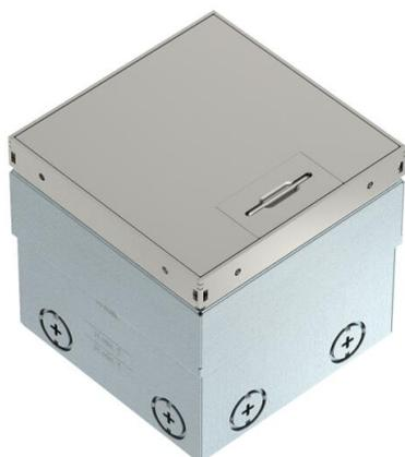
Quadratische Bodensteckdose für den Einsatz in trocken gepflegten Holzböden und Estrichböden im Innenbereich. Einbaugehäuse mit vorgeprägten Einführungsöffnungen für Rohre (M20/M25). Oberteil durch 4 Nivellierstützen auf Oberkante Bodenbelag einstellbar. Die Mindesteinbautiefe beträgt 100 mm, der Nivellierbereich + 35 mm.
