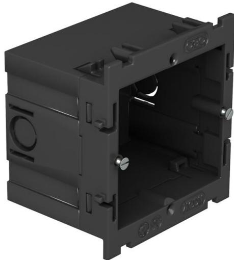
Geräteeinbaudose zur Aufnahme von Standard Schalt- und Steckgeräten in Tragring und Tragbügelausführung aller Hersteller. Durch eine extragroße Einbauöffnung ist die Dose besonders zur Aufnahme von ELKO- Geräten sowie größere Ausführungen von Anschlussdosen für Datentechnik geeignet. Bei der Anwendung für Datentechnik kann falls erforderlich auf das Schutzgehäuse verzichtet werden.
