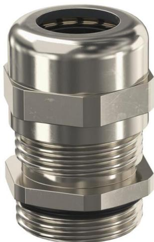
Robuste Kabelverschraubung mit metrischem Anschlussgewinde nach IEC 423 in Hutmutterbauart für hohe Dichtigkeitsansprüche. Zugentlastung, Verdreh-schutz und Dichtigkeit über den gesamten Spannbereich. Dichtring aus Neopren. Klemmeinsatz aus Polyamid. Mit vormontiertem Dichtring am Anschlussgewinde, VDE-geprüft nach DIN EN 50262, Schutzart IP68 bei 5 bar/1h, Temperaturein-satzbereich -20 bis +100°C.
