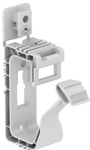
Sammelhalterung mit angespritztem Befestigungselement, zum Montieren von bis zu 20 Leitungen NYM 3 x 1,5 mm<sup>2</sup> an Wand oder Decke. Befestigung mit Schlagdübel oder Steckdübel. Auch geeignet zum Befestigen mit gas- und akku-betriebenen Setzgeräten der Marken Bosch, Fischer und Spit (Nasendurchmesser innen Ø 7 mm). Befestigungsloch Ø 6 mm. Empfohlener Befestigungsabstand bei voller Belegung 250-400 cm, abhängig von den jeweilig gültigen nationalen Vorgaben/Normen.
