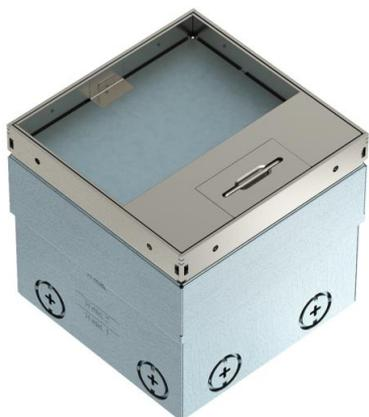
Quadratische Bodensteckdose für den Einsatz in trocken gepflegten Holzböden und Estrichböden im Innenbereich. Einbaugehäuse mit vorgeprägten Einführungsöffnungen für Rohre (M20/M25). Oberteil durch 4 Nivellierstützen auf Oberkante Bodenbelag einstellbar. Die Mindesteinbautiefe beträgt 110 mm, der Nivellierbereich + 25 mm.
