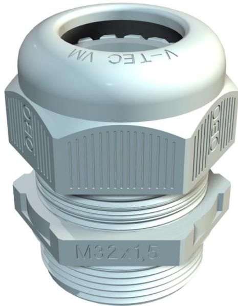
Kabelverschraubung mit metrischem Anschlussgewinde in Hutmutterbauart, für Kabelabzweiggästen, Gehäuse, Verteilerkästen im privaten und industriellen Bereich. Mit Zugentlastung und integrierter Dichtlippe, geprüft nach DIN EN 62444. Schutzklasse IP68. Einsetzbar von -20°C bis +65°C.
