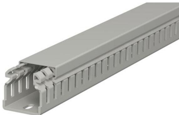
Verdrahtungskanal nach DIN EN 50085-2-3 inkl. Oberteil und Bodenlochung zur waagerechten und senkrechten Verlegung elektrischer Kabel und Leitungen im Schaltschrank. Ausführung als DIN-Kanal. Das Ausbrechen der Stege erfolgt werkzeuglos. Bodenbündiges Ausführen ist durch Sollbruchstellen möglich. Geprüft nach DIN EN 50085-2-3. Sonderlängen auf Anfrage.
