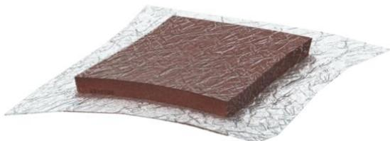
Vakuum verpackte Ausführung des Schaumblocks FBA-B200-14 für den einfachen Verschluss der Restspalte im Kombischott PYROPLUG® Block. Nach Abschluss der Montage wird die Folie eingeschnitten und der Block dehnt sich wieder bis zu seiner Ursprungsgröße aus. Die Folie kann in der Abschottung verbleiben. Anwendung im Innenbereich.
