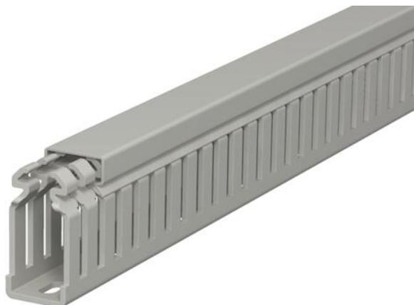
Verdrahtungskanal nach DIN EN 50085-2-3 inkl. Oberteil und Bodenlochung zur waagerechten und senkrechten Verlegung elektrischer Kabel und Leitungen im Schaltschrank. Ausführung als DIN-Kanal. Das Ausbrechen der Stege erfolgt werkzeuglos. Bodenbündiges Ausführen ist durch Sollbruchstellen möglich. Geprüft nach DIN EN 50085-2-3. Sonderlängen auf Anfrage.
