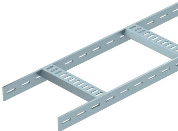
Schiffsbau-Kabelleiter mit gelochtem Seitenholm in der Seitenhöhe 40 mm mit eingeschweißten, nach unten offenen und gelochten Trapezsprossen. Belastung geprüft nach IEC in Kombination mit Verbinder Typ SLV.
