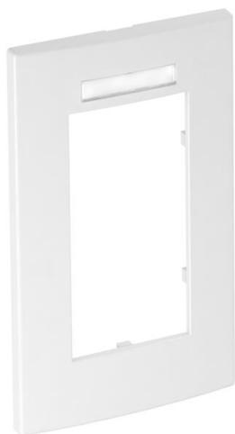
Frontrastender Abdeckrahmen für Modul 45 Einbaugeräte, 2fach, mit Beschriftungsfeld für senkrechte Geräteinstallation, zum Rasten in Geräteeinbaudose 71GD13 oder in Montageträger 71MT2 45.
