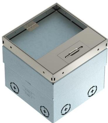
Quadratische Bodensteckdose für den Einsatz in trocken gepflegten Holzböden und Estrichböden im Innenbereich. Einbaugehäuse mit vorgeprägten Einführungsöffnungen für Rohre (M20/M25). Oberteil durch 4 Nivellierstützen auf Oberkante Bodenbelag einstellbar. Die Mindesteinbautiefe beträgt 110 mm, der Nivellierbereich + 25 mm.
