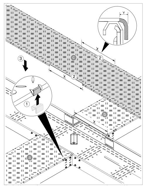
Abb. 23: Montage Deckel bei Kreuzverbindung
