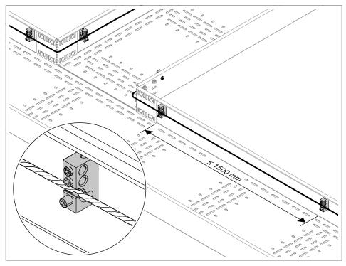
Abb. 14: Abstand Anschlussklemme, System auf Profilschiene ("Montage")
