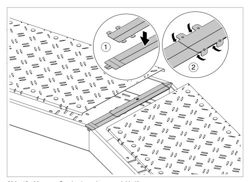
Abb. 18: Montage Staubschutzelement mit Verlängerung
