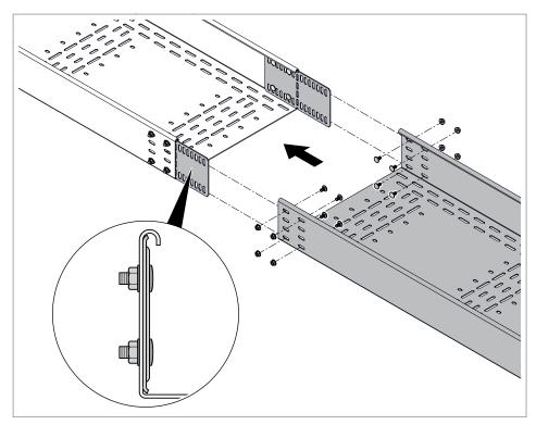
Abb. 6: Gerade Verbindung
