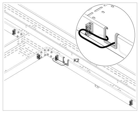
Abb. 16: Abstand Anschlussklemme, System auf Profilschiene ("Fördertechnik")
