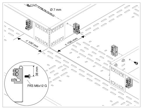
Abb. 13: Befestigung Anschlussklemme System auf Profilschiene ("Montage")
