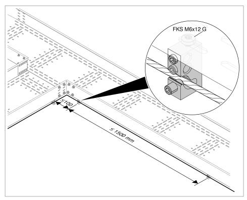
**Abb. 12:** Befestigung Anschlussklemme aufgeständertes System
