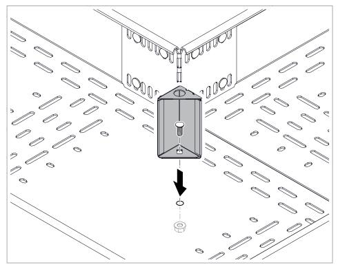
Abb. 17: Montage Deckelstütze
