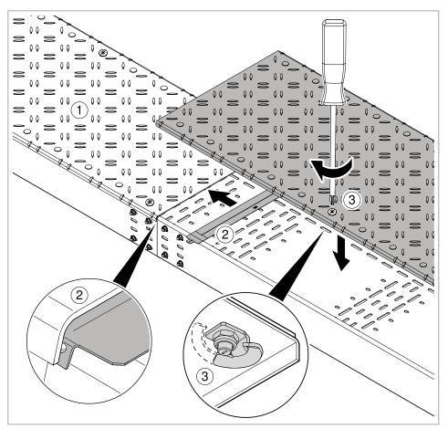
Abb. 21: Montage Deckeltyp DBKR mit Drehriegel
