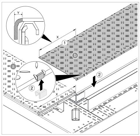
Abb. 22: Montage Deckel bei Eckverbindung
