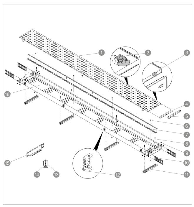
Abb. 2: Systemkomponenten Fördertechnikrinne, nicht begehbar
