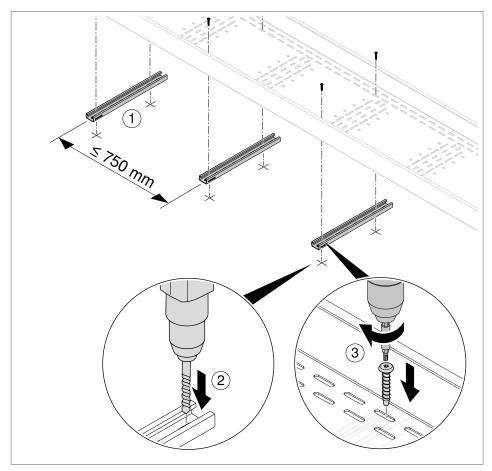
Abb. 3: Montage Profilschiene
