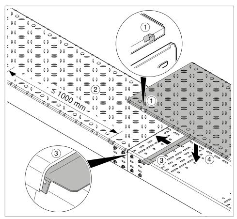
Abb. 19: Montage Deckel DBKR mit Deckelklammern
