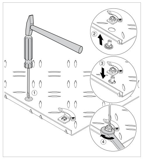
Abb. 20: Montage Drehriegel Typ DRL H S FT
