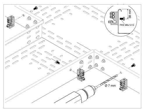
Abb. 15: Befestigung Anschlussklemme, System auf Profilschiene ("Fördertechnik")
