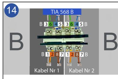
14 In dieser Abbildung wird die Belegung gemäß **TIA-568 B** gezeigt.
