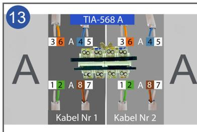
13 In dieser Abbildung wird die Belegung gemäß **TIA-568 A** gezeigt.
