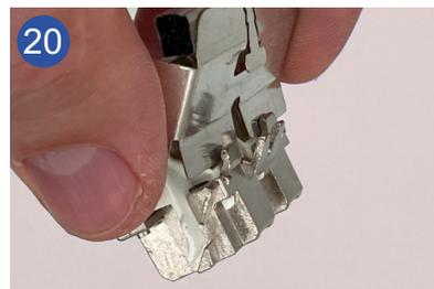
20 Das Schirmblech muss dabei an der Vorderseite mit seinen schräg aufgekanteten Kontaktflächen unter die beiden Metallkontakte vom Anschlussmodul geführt werden.
