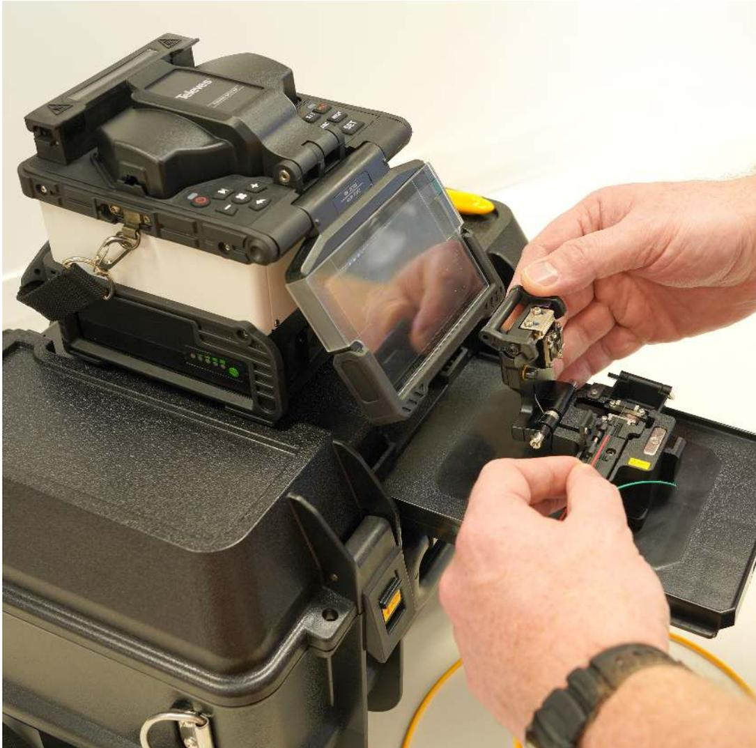
Die integrierte Ablage im Koffer kann das Spleißgerät tragen und bietet einen übersichtlichen und beweglichen Arbeitsbereich. Wir empfehlen, die Innenseite des Koffers mit einem Gewicht zu beschweren, um die Stabilität während des Gebrauchs zu gewährleisten.
