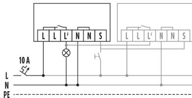
Standardbetrieb mit optionaler Ansteuerung durch Schließaster und Parallelschaltung von max. 8 Geräten
