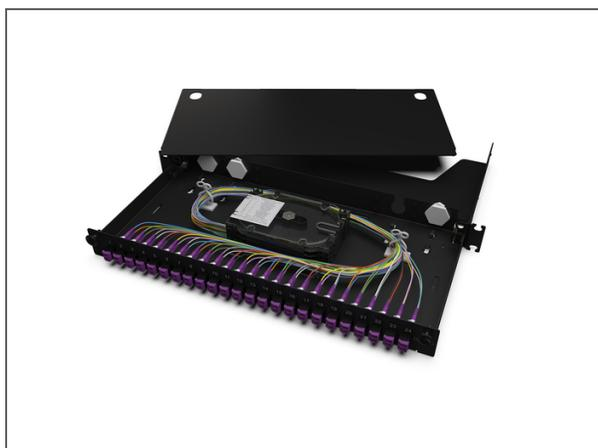
Everon® LAN1 Glasfaser Verteilerfeldgehäuse, vorbestückt mit selbstschließenden LC PC Duplex Adaptern und Pigtails, 48 Fasern, 1 HE, Multimode OM4, universelle Spleißpakete für Schrumpf-/Krimpspleißschutz, ohne Spleißschutz, schwarz
