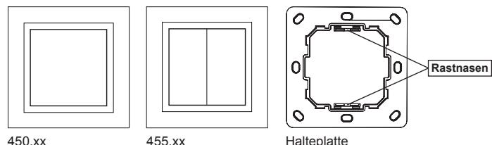
Der Easyfit Wandsender ist ein universeller, äußerst flacher Schaltereinsatz, der in zahlreiche Rahmenprogramme verschiedener Hersteller integriert werden kann. Der Universaleinsatz ist kompatibel zu den in der Tabelle stehenden Schalterprogrammen. Die Integration in den Rahmen erfolgt dabei ähnlich, wie bei Universaleinsätzen für Antennensteckdosen.
