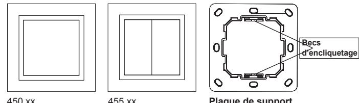
L'émetteur mural easyfit est un insert de commutation universel extra-plat, qui peut être intégré à de nombreuses gammes d'autres fabricants. L'insert universel est compatible avec les gammes de commutateurs mentionnés dans le tableau. L'intégration dans les cadres se fait comme pour les inserts universels des prises d'antenne.
