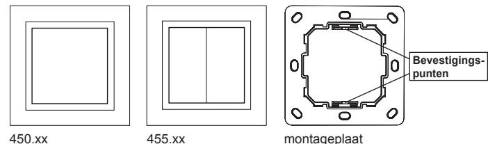
De Easyfit-wandzender is een universele, superplatte standaardbesturing die in talrijke productprogramma's van diverse fabrikanten ingepast kan worden. De universele wandzender is compatibel met de schakelprogramma's in de tabel. Inbouw in het frame gebeurt op dezelfde manier als bij de universele inbouwelementen voor antennicontactdozen.
