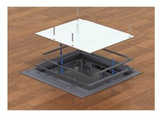
Stahlblechdeckel und Kunststoffplatte entfernen, Distanzleisten einlegen oder entfernen, Platte einlegen und Deckel wieder festschrauben.
