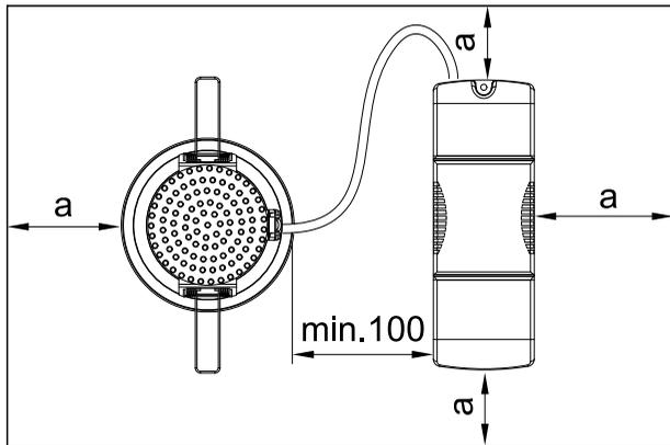
$a_{\min} = 75\text{mm}$      $b_{\min} = 0\text{mm}$
