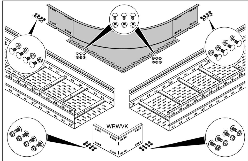
Abb. 38: Bauteile für Montage Eckanbaustück WEAS
