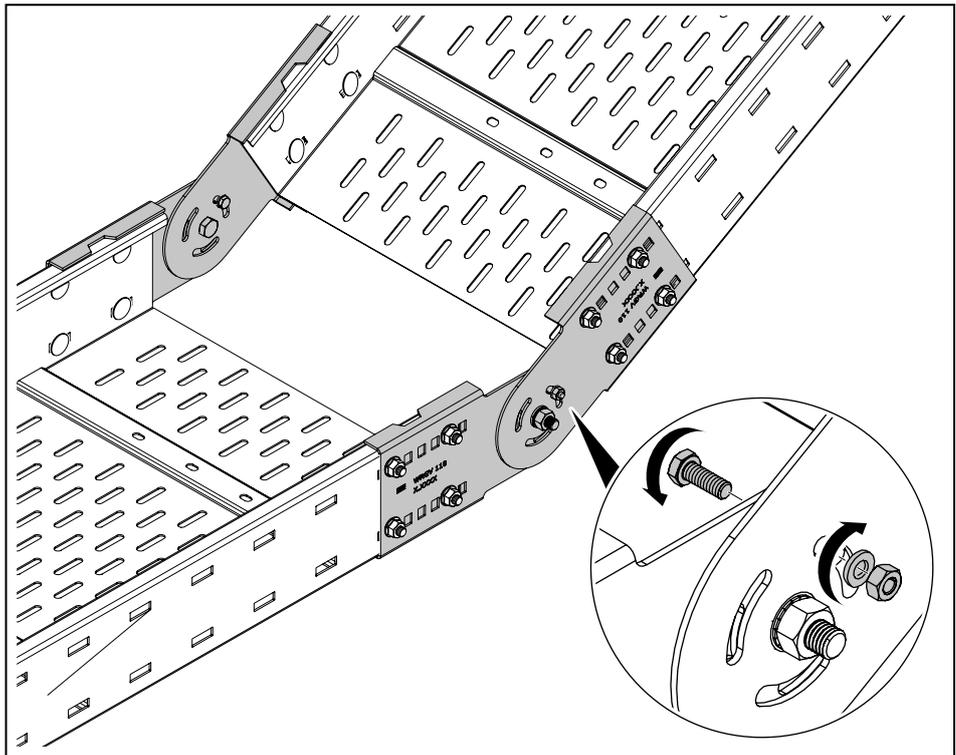
**Abb. 25:** Steigende Rinne montieren
