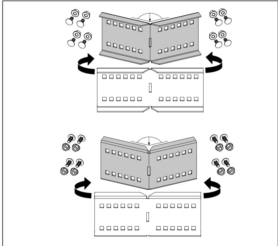
**Abb. 20:** Winkelverbinder WRWVK für Innen- und Außenwinkel biegen
