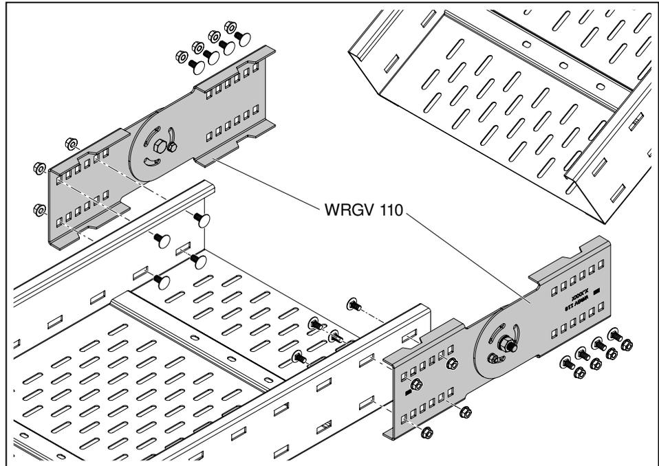
**Abb. 23:** Gelenkverbinder ansetzen
