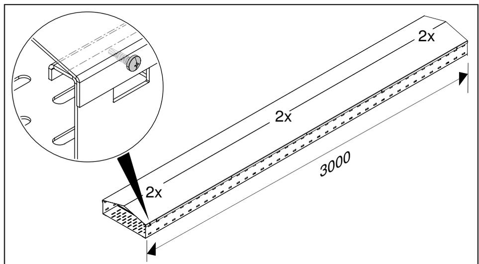
**Abb. 43:** Deckel mindestens an 6 Stellen anschrauben
