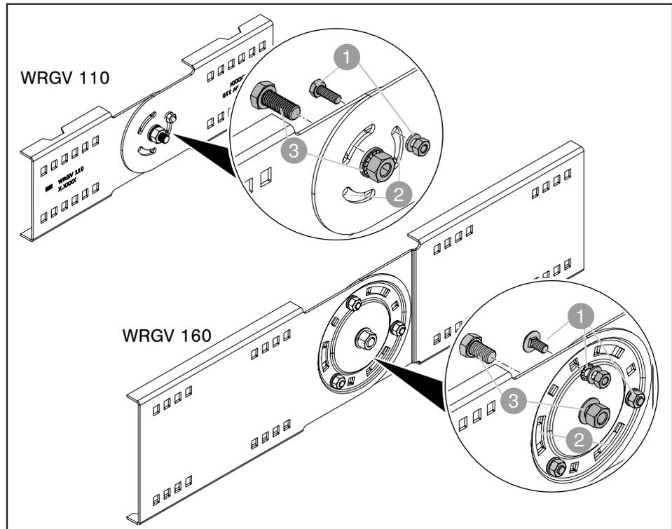
**Abb. 22:** Übersicht Gelenkverbinder WRGV
