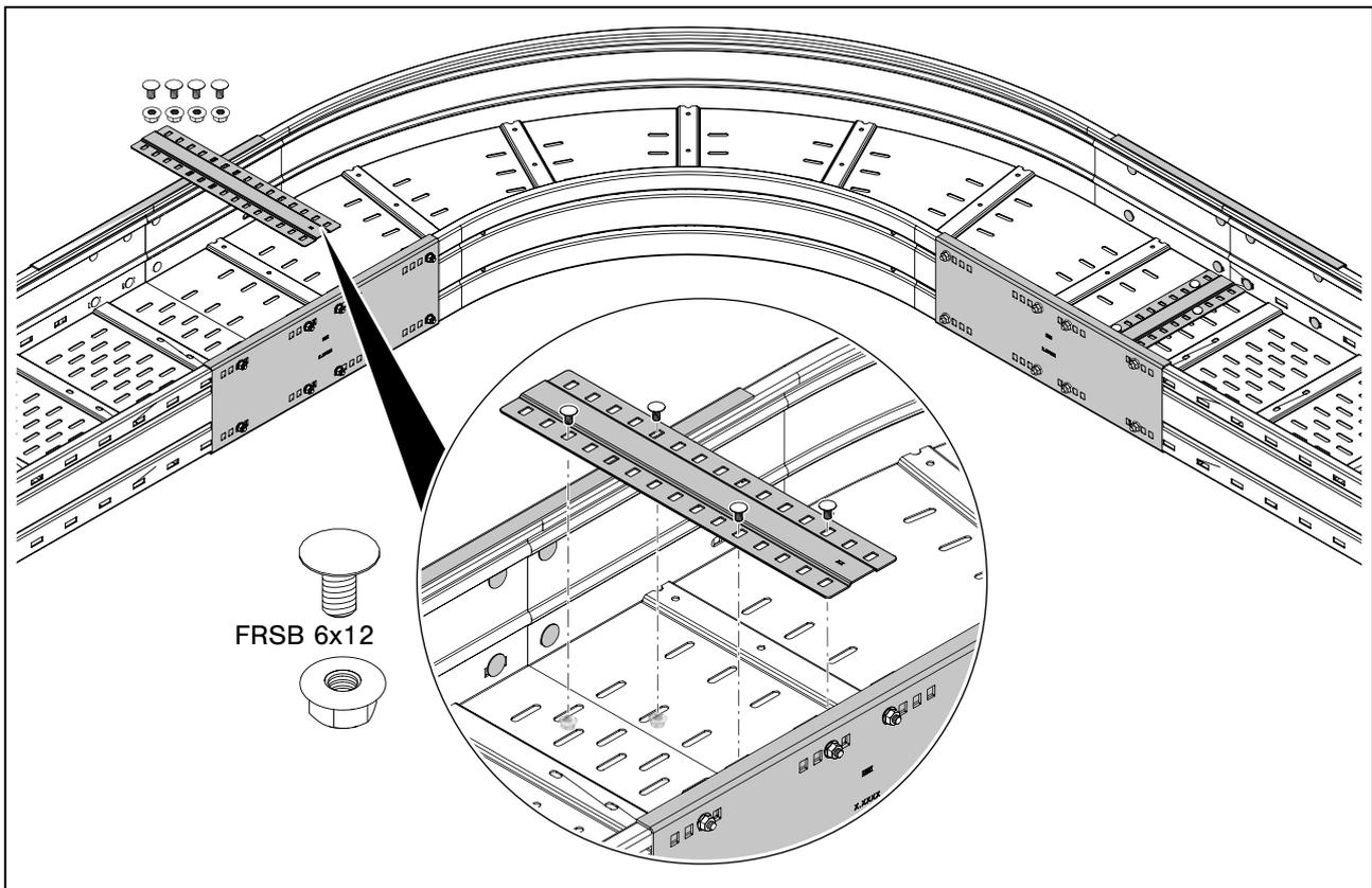
**Abb. 33:** Stoßstellenleiste anschrauben
