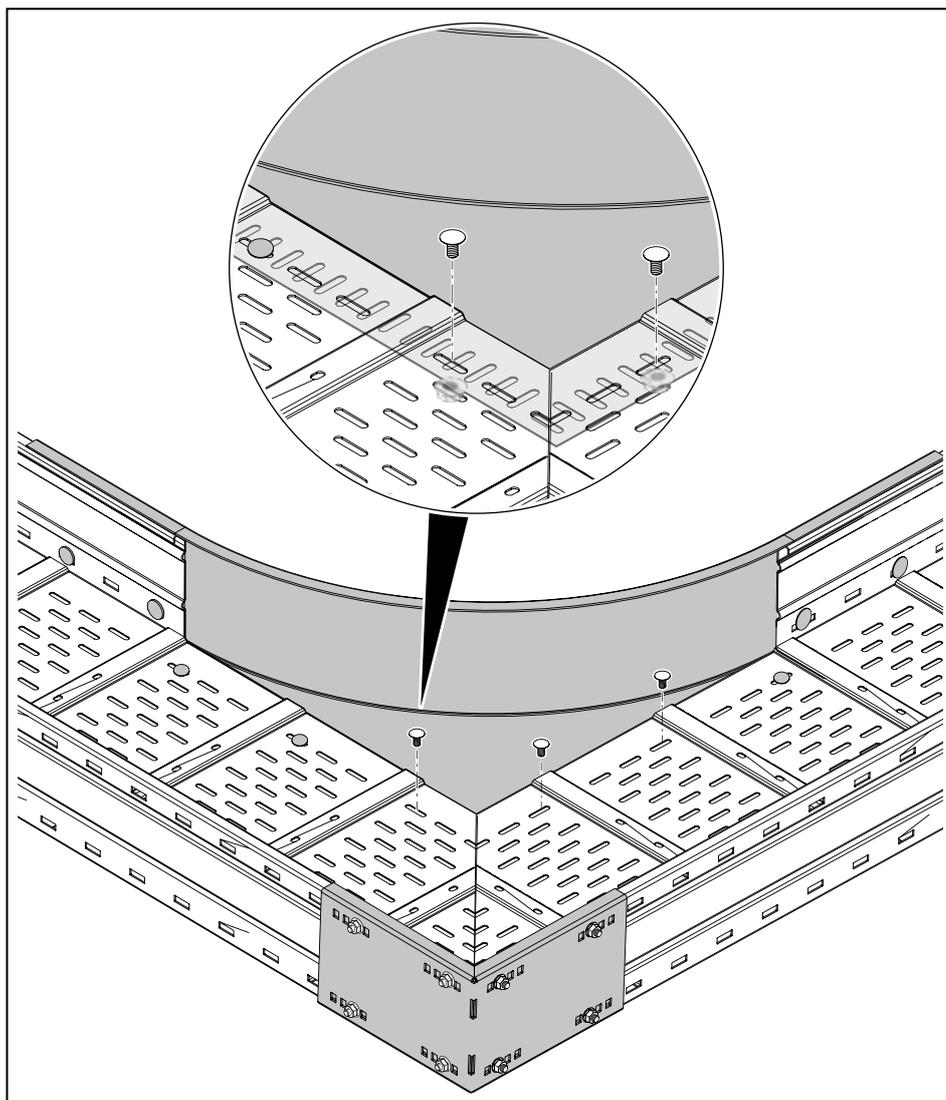
**Abb. 41:** Stoßstellenleiste anschrauben
