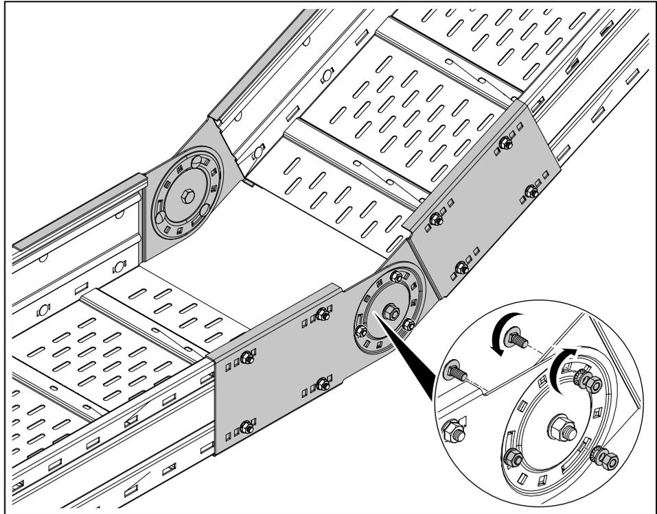
**Abb. 28:** Steigende Rinne montieren
