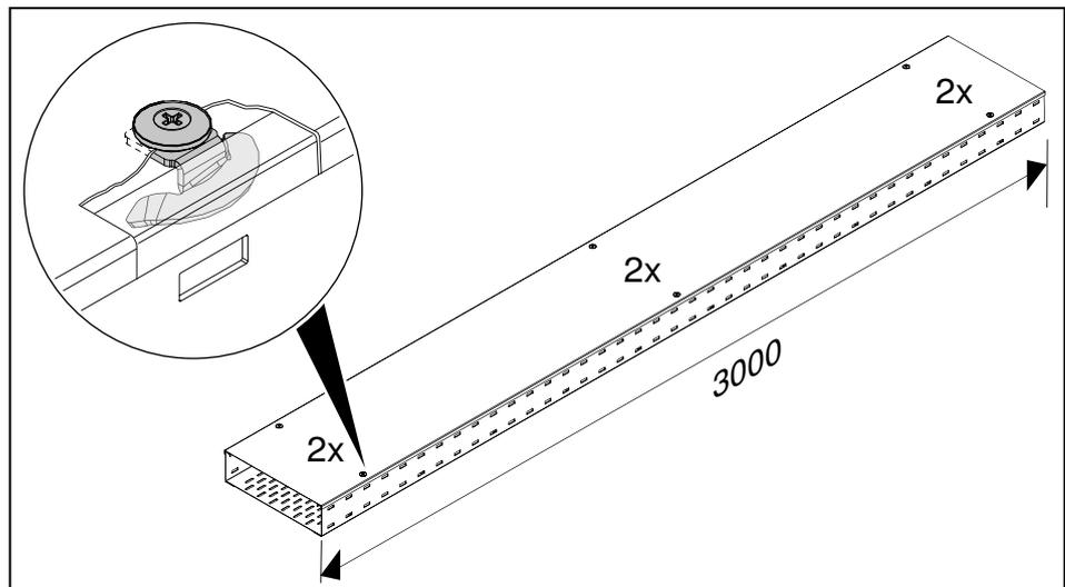
**Abb. 45:** Montierter Deckel mit vormontierten Drehriegeln
