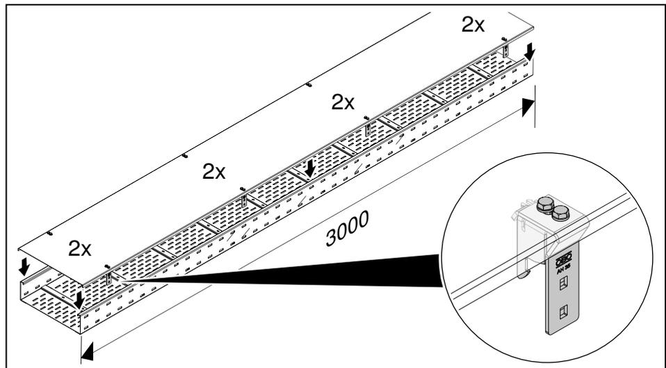
Abb. 47: Montierte Abstandhalter an Deckel DRL FAM
