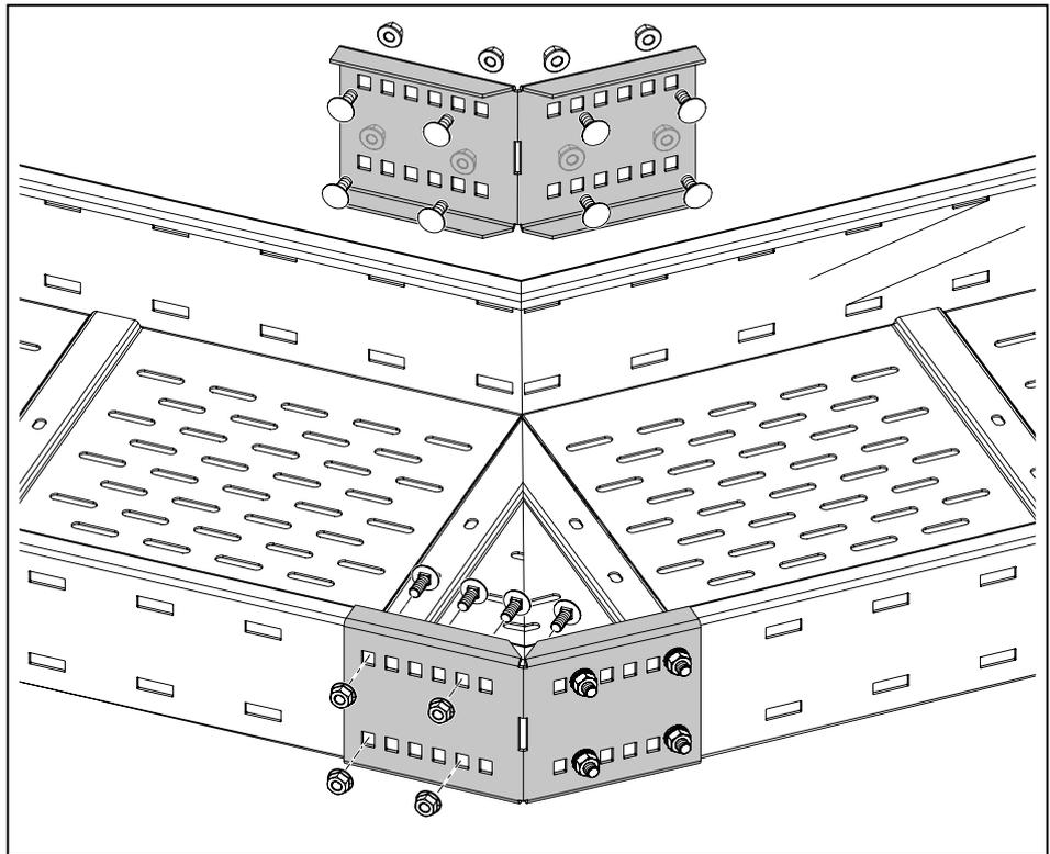
**Abb. 21:** Winkelverbinder WRWVK am Innen- und Außenwinkel anschrauben
