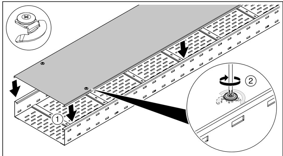
**Abb. 44:** Deckel WDRL auf Weitspannkabelrinne aufsetzen
