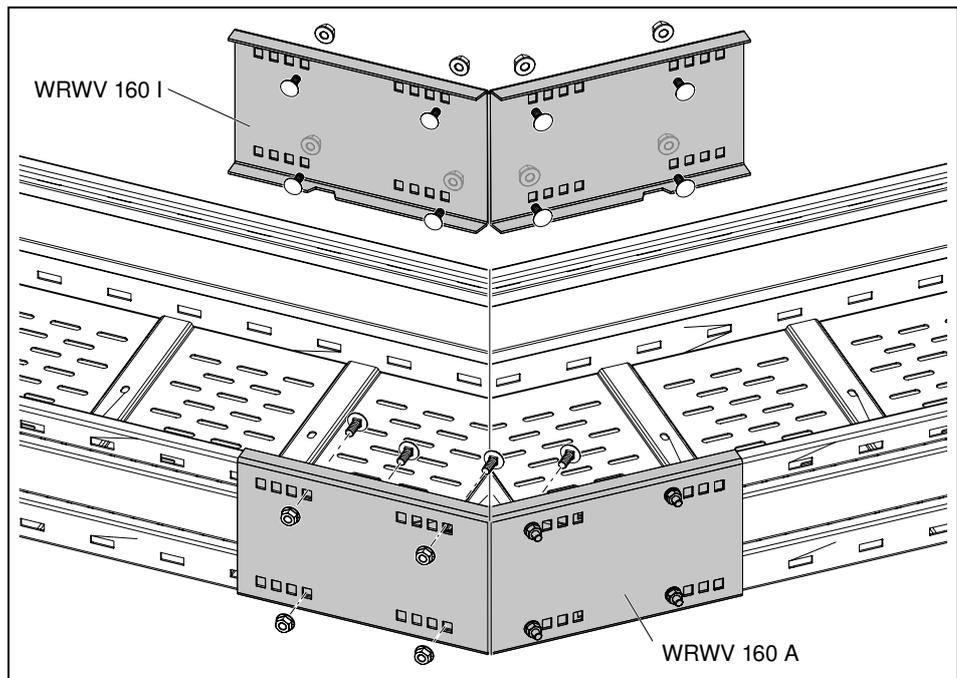
**Abb. 19:** Winkelverbinder WRWV am Innen- und Außenwinkel anschrauben
