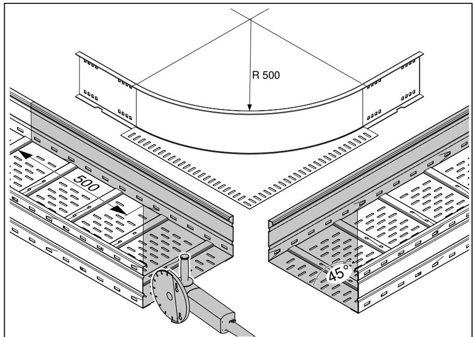
Abb. 39: Weitspannkabelrinne schneiden für Eckanbaustück
