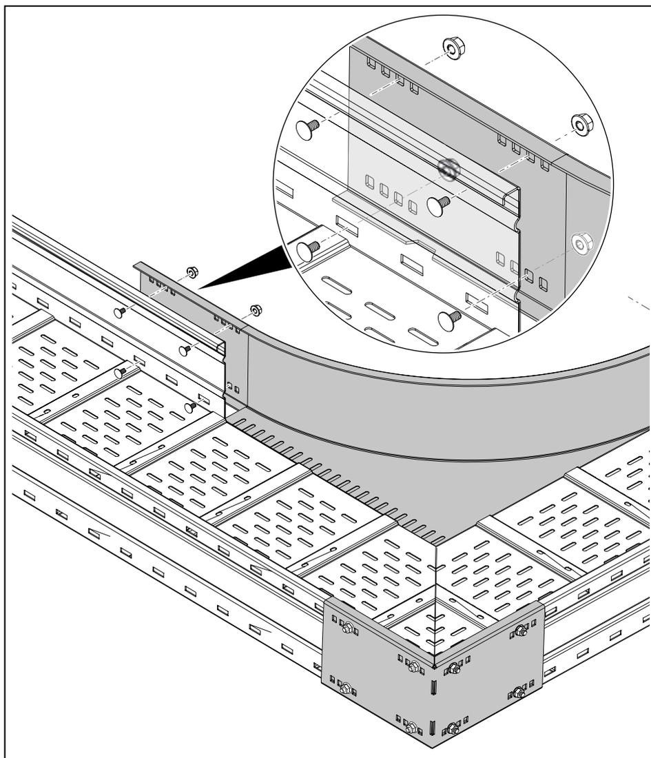
**Abb. 40:** Eckenbaustück und Winkelverbinder anschrauben
