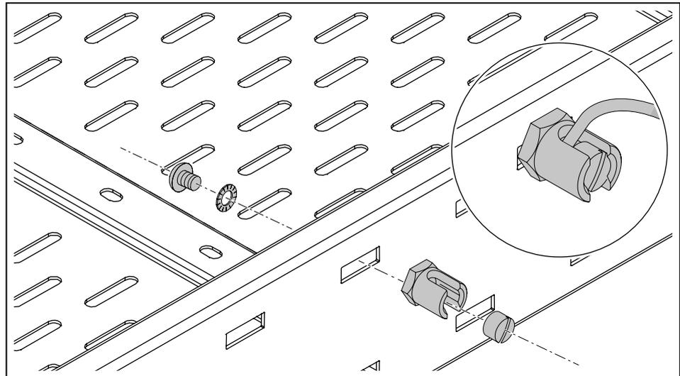
**Abb. 49:** Erdungsklemme montieren
