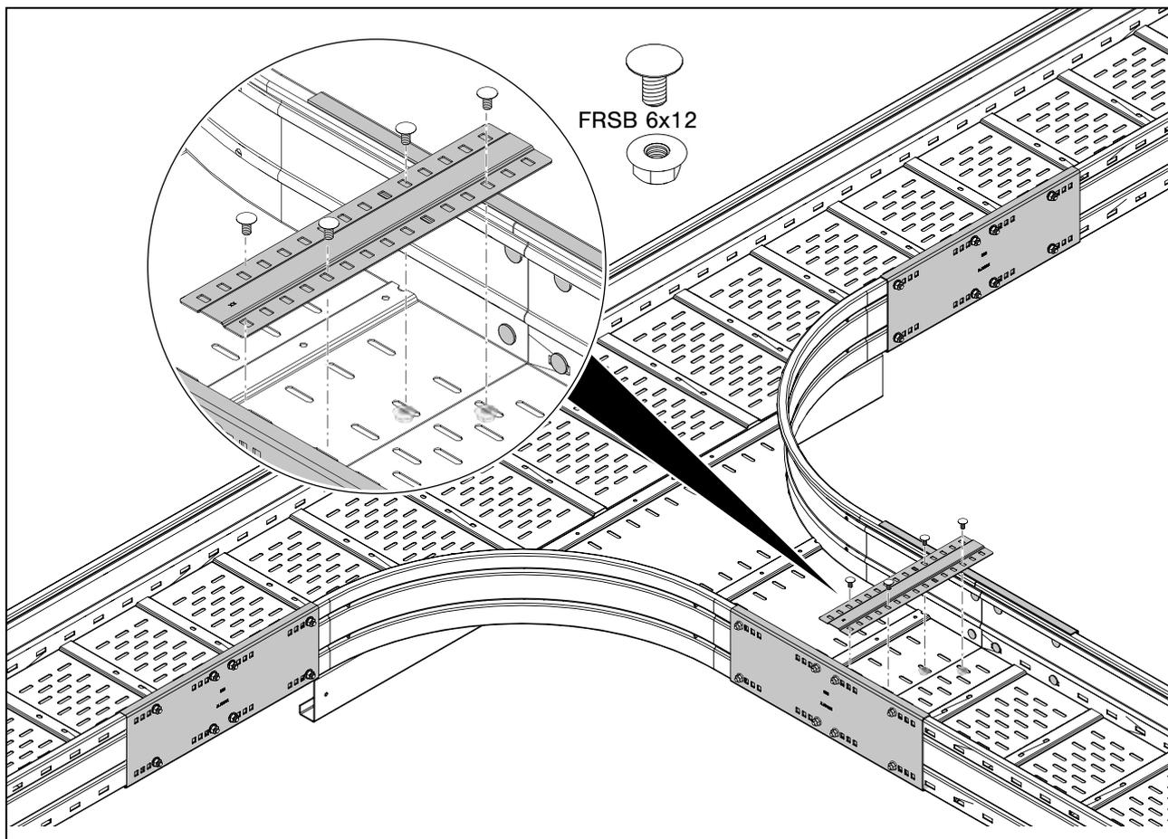
**Abb. 37:** Stoßstellenleiste anschrauben
