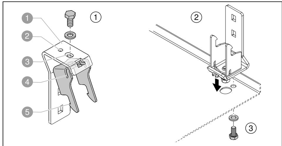
**Abb. 46:** Abstandhalter an Deckel montieren
