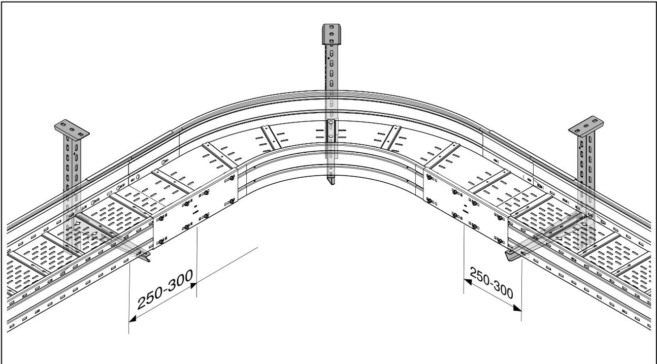
**Abb. 30:** Beispiel Unterstützung Formteil Bogen 90° mit 400 mm Breite
