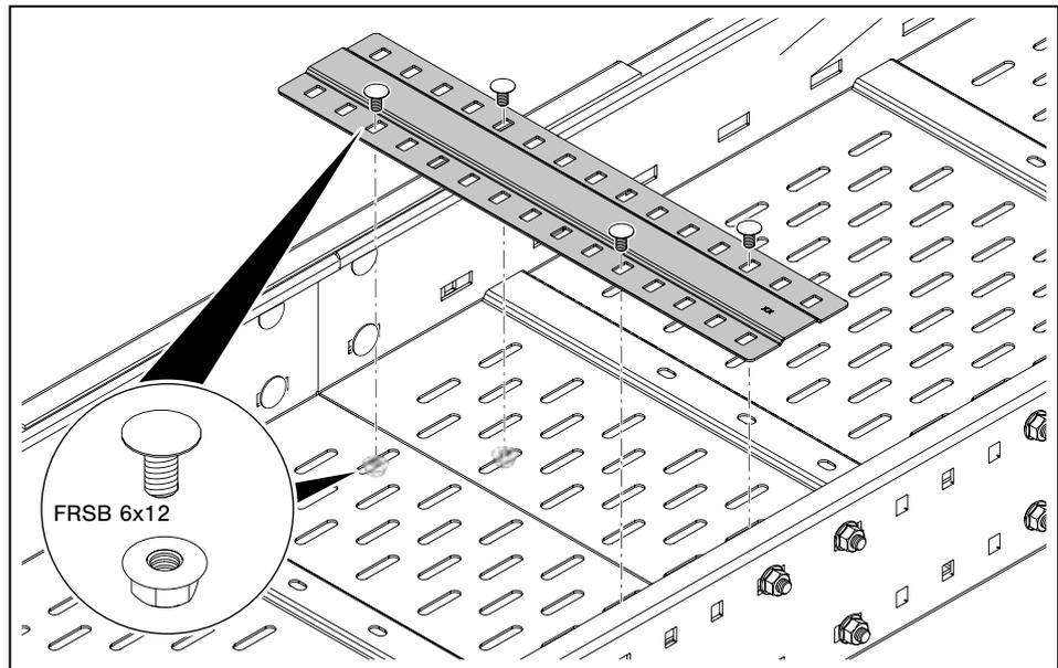
**Abb. 16:** Stoßstellenleiste montieren
