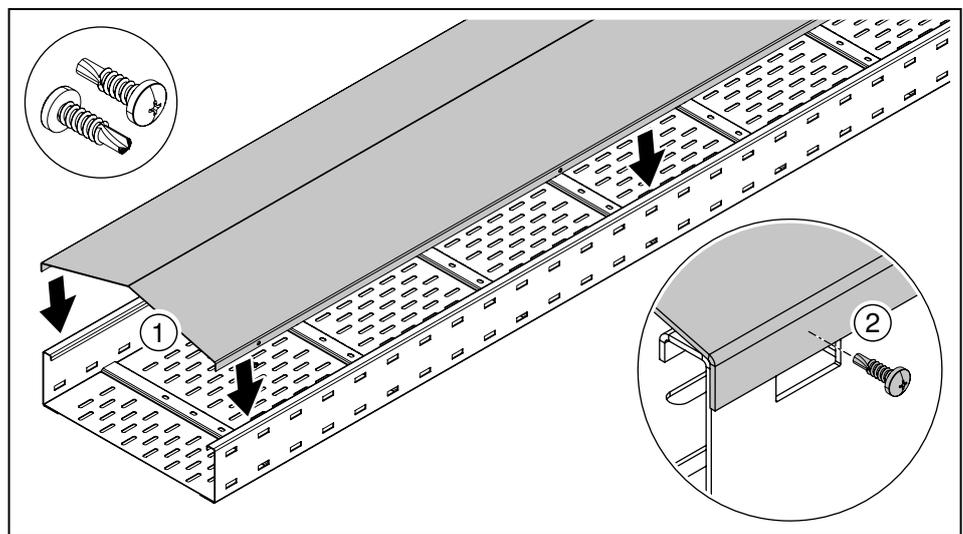
**Abb. 42:** Deckel WDRLU DF auf Weitspannkabelrinne setzen
