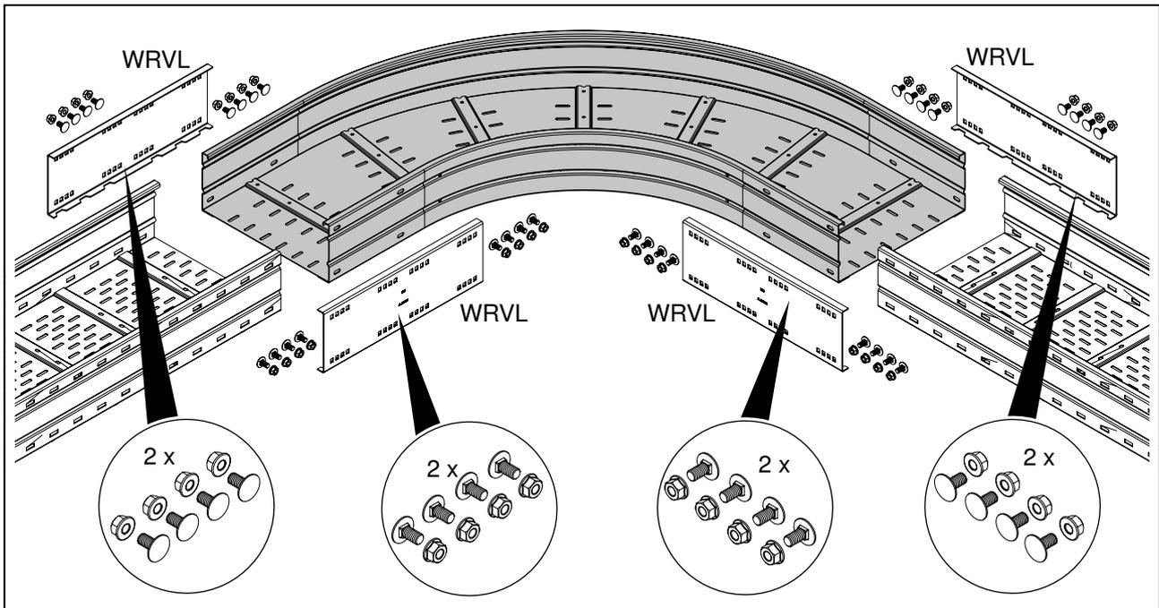
Abb. 31: Bauteile für Montage Bogen 90° Seitenhöhe 160 mm
