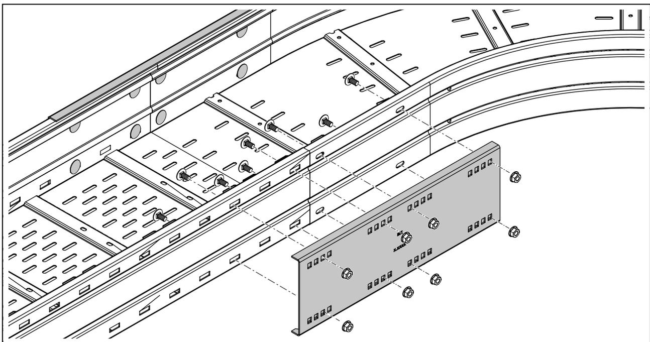
Abb. 32: Verbinder anschrauben
