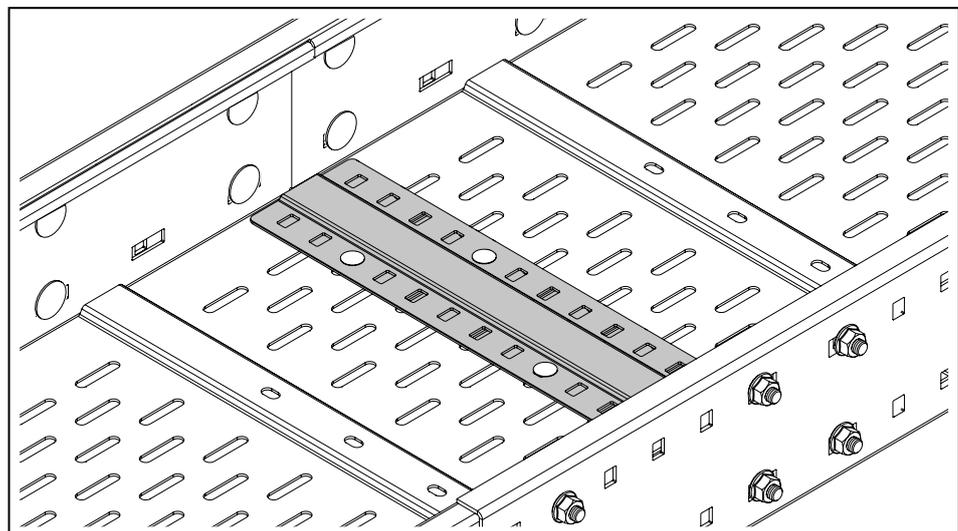
**Abb. 17:** Montierte Stoßstellenleiste
