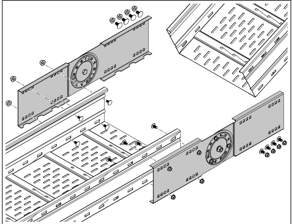
Abb. 26: Gelenkverbinder ansetzen
