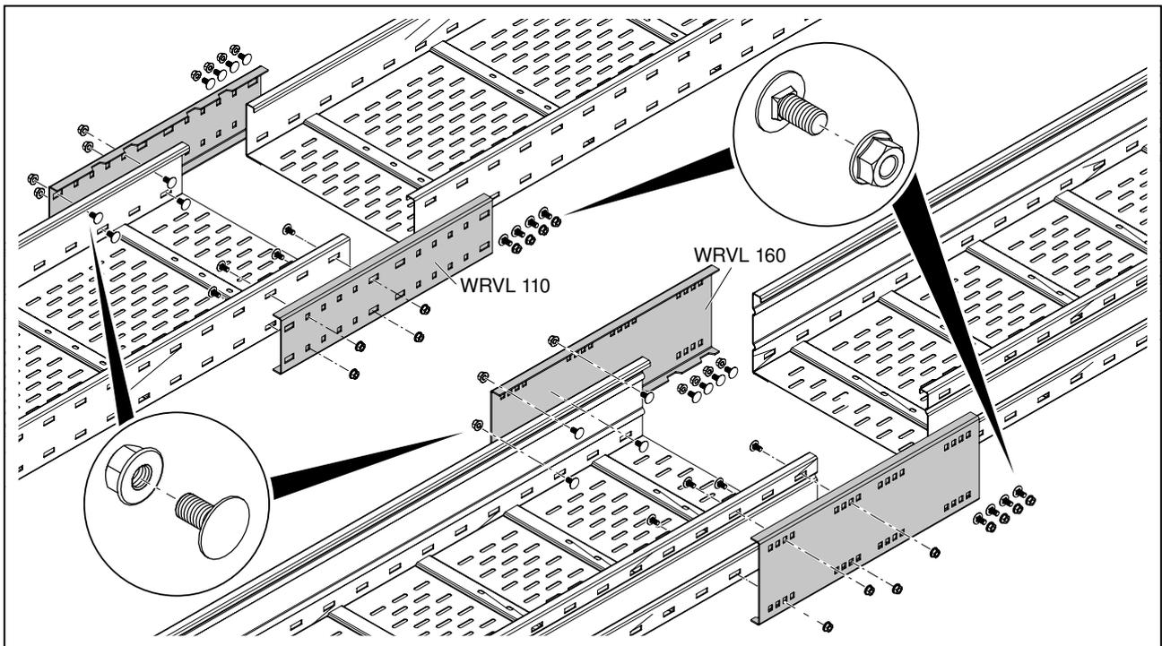
**Abb. 14:** Längsverbinder WRVL 110 und 160 ansetzen
