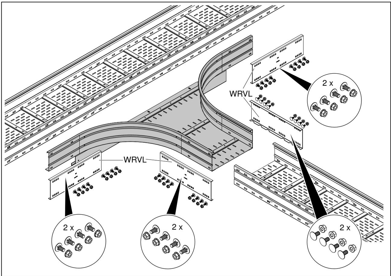
Abb. 34: Bauteile für Montage Anbau-Abzweigstück
