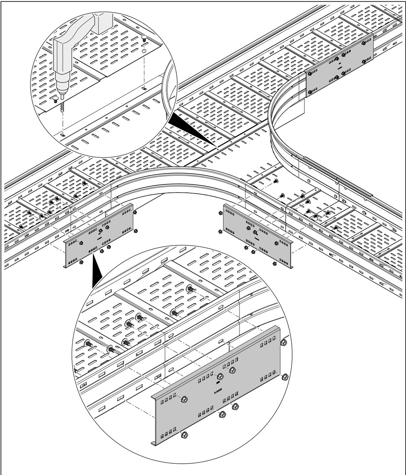
**Abb. 36:** Längsverbinder anschrauben
