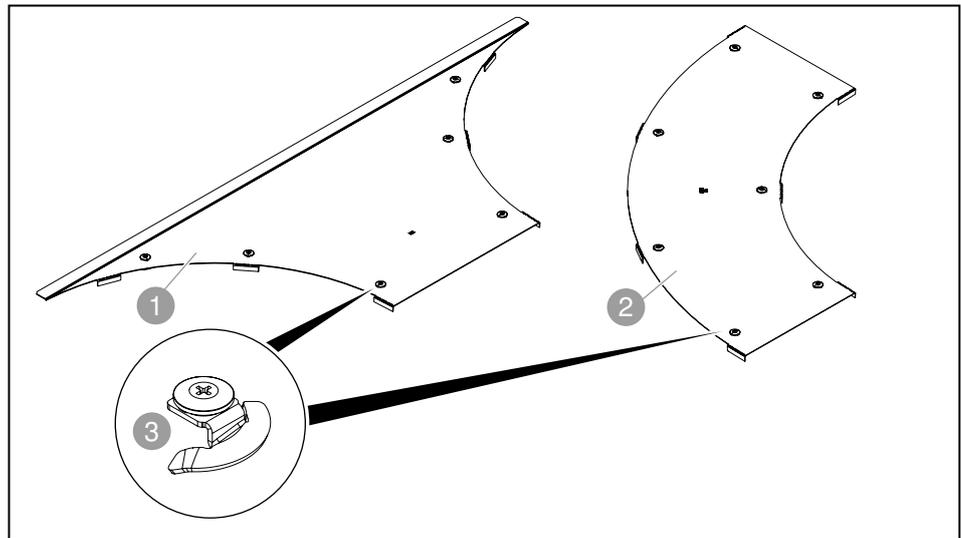
Abb. 10: Deckel für Formteile
