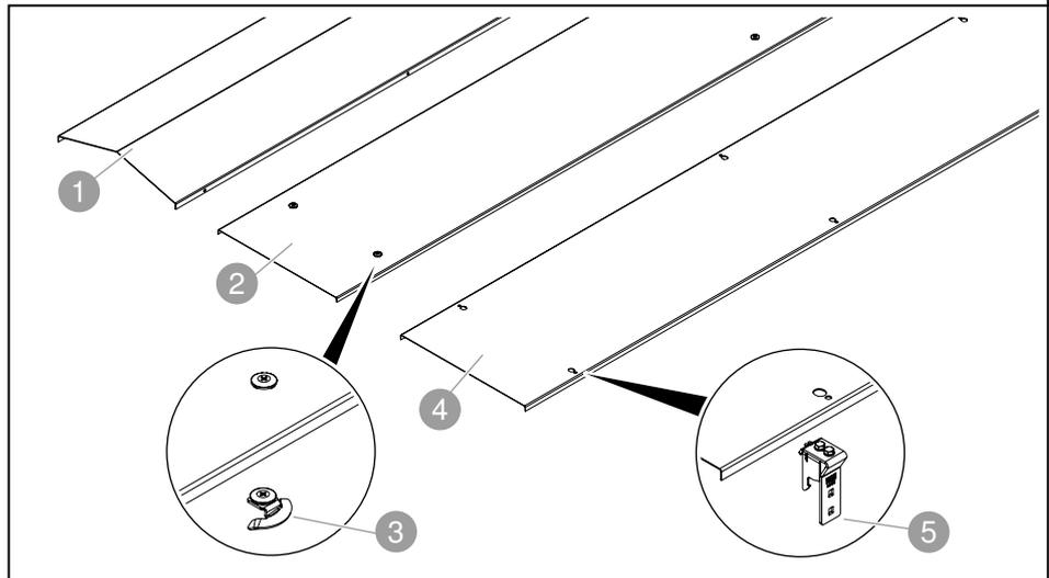
**Abb. 8:** Deckel mit Befestigungsmaterial
