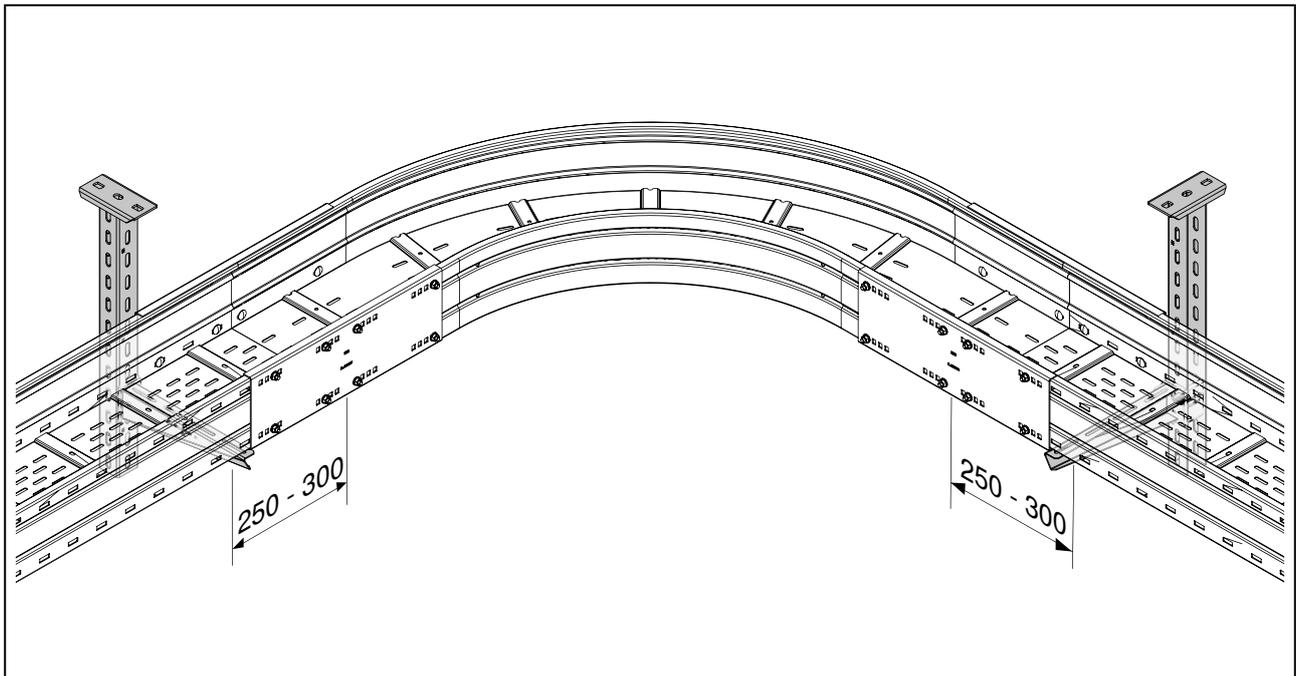
**Abb. 29:** Beispiel Unterstützung Formteil 90°-Bogen mit 300 mm Breite
