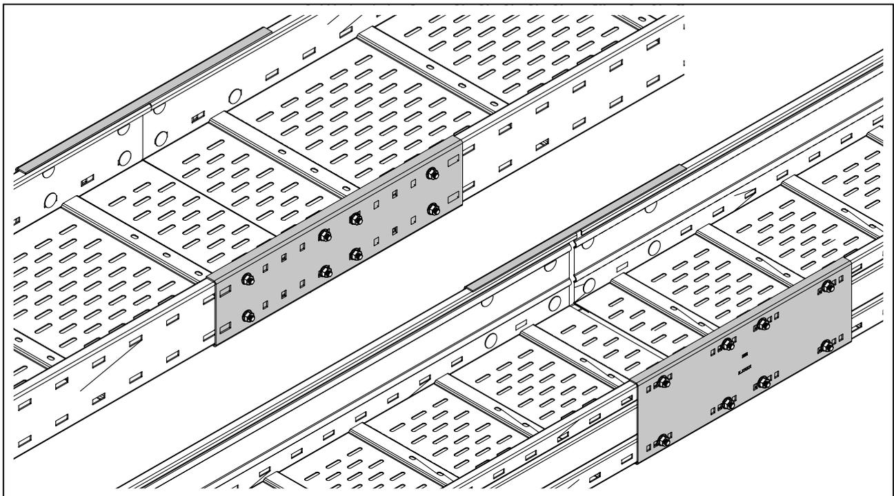
**Abb. 15:** Längsverbinder WRVL anschrauben
