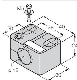
Befestigungsschelle für Gewinderohrsensoren, mit Festanschlag; Werkstoff: PA6
