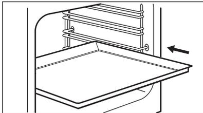
Schieben Sie das Backblech oder die Auflauffanne zwischen die Führungsschienen der Einhängegitter. Stellen Sie sicher, dass es die Rückwand des Backofens nicht berührt.
