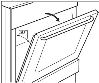
2. Fassen Sie die Türabdeckung (B) an der Oberkante der Tür an beiden Seiten an. Drücken Sie sie nach
