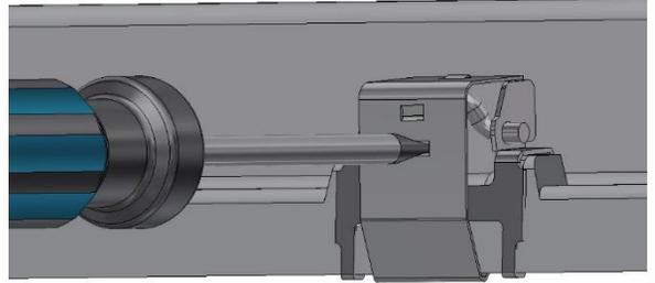
Je nach Ausführung der Leuchte ist das Gehäuse mit einer unterschiedlichen Anzahl von Sicherheitsverschlüssen versehen. Diese sind mit einem Schlitzschraubendreher mit 4 mm Klingenbreite gemäß obiger Anleitung zu öffnen und zu schließen.
