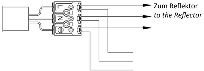
Durchgangsverdrahtung 5 polig
