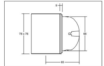
LED-Wandeinbauleuchte, für Gerätedosen, schwarz, quadratisch. Einbaumontage, Wandmontage. Zur Installation in Hohlwand- oder Betongerätedosen mit einer Einbautiefe von mind. 62 mm (Schraubabstand: 60 mm).
