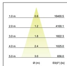
LED-Schienenstrahler, strukturschwarz, rund. Ausführung in kompakter Bauform für die harmonische Implementierung in stimmige, architektonische Raumkonzepte. Wärmeableitung: passiv (ohne Lüfter), Inkl. Betriebsgerät, schaltbar, (230 V AC 50 Hz). Leuchte inkl. Euro-Adapter für Standard-3-Phasen-Schienen.
