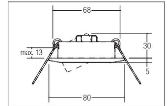
Deckeneinbau-Lautsprecher, DA 68 mm, nickel matt, rund. Ausgeführt in kompakter Bauform für werkzeuglose Schnellmontage zum Deckeneinbau. Nenn- / Musikbelastbarkeit: 3 / 4 W, Impedanz: 20 Ohm
