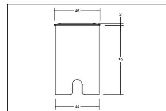
LED-Bodeneinbauleuchte HYBRIDE MINI, V4A, IP65, edelstahl, rund. Einbaumontage, Bodenmontage Montageart: Einbaumontage, Montageort: Bodenmontage, Material: Edelstahl V4A / Aluminium / Glas, Schutzart: nach DIN EN 60529: IP65, Schutzklasse: (EN 61140) III, Spannung: 24V, Leistung: 1.4W, Anzahl der Leuchtmittel / Fassungen: 1.0 Stk, Lichtstrom: 18lm, Farbtemperatur: 3000 K, Lichtfarbe: weiß, Abstrahlwinkel: 100°, ohne Betriebsgerät.
