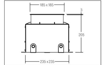
LED-Bodeneinbauleuchte, V4A, IP67, edelstahl, quadratisch. Einbaumontage, Bodenmontage. Montageart: Einbaumontage, Montageort: Bodenmontage, Material: Edelstahl / Aluminium / Glas, Schutzart raumseitig: nach DIN EN 60529: IP67, Schutzklasse: (EN 61140) I, Spannung: 230V AC 50Hz, Leistung: 11.8W, Anzahl der Leuchtmittel / Fassungen: 1.0 Stk, Lichtstrom: 710lm, Farbtemperatur: 3.000 K, Abstrahlwinkel: 115°, mit Betriebsgerät, Art der Dimmung: schaltbar.
