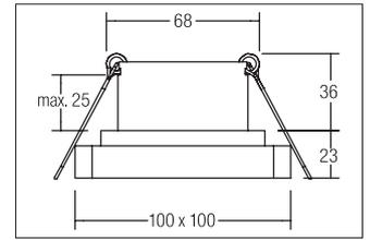
LED-Einbaudownlight QUBIC, mit Indirektanteil, strukturweiß, quadratisch. Ausgeführt in kompakter Bauform für werkzeuglose Schnellmontage zum Deckeneinbau. LED-Deckeneinbaudownlight mit indirektem Lichtanteil.
