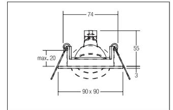
Einbaustrahler, GX5,3, weiß, quadratisch. Ausgeführt in kompakter Bauform für werkzeuglose Schnellmontage zum Deckeneinbau. Ausführung: GX5,3, Montageart: Einbaumontage, Montageort: Deckenmontage, Material: Aluminium, Schutzart raumseitig: nach DIN EN 60529: IP20, Schutzklasse: (EN 61140) III, Spannung: 12V, Leistung: 50W, Anzahl der Leuchtmittel / Fassungen: 1.0 Stk, Lichtfarbe: weiß, Verstellbarkeit: schwenkbar, Art der Dimmung: abhängig vom Betriebsgerät .
