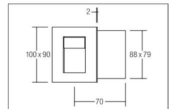
LED-Wandeinbauleuchte, edelstahl, rechteckig. Einbaumontage, Wandmontage. Lieferung inkl. Einputzgehäuse, B: 88 mm, H: 79 mm, ET: 70 mm,
