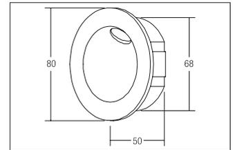
LED-Wandeinbauleuchte, IP54, strukturweiß, rund. Einbaumontage, Wandmontage. Zum Einbau in Hohlwände mittels Blattfedern.
