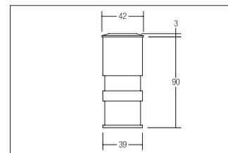
LED-Bodeneinbauleuchte, IP65, edelstahl, rund. Einbaumontage, Bodenmontage. Inkl. Montagehülse und 150 mm Anschlussleitung. Ausführung: Plug&Play, Montageart: Einbaumontage, Montageort: Bodenmontage, Material: Edelstahl / Aluminium / Kunststoff / Glas, Schutzart raumseitig: nach DIN EN 60529: IP65, Schutzklasse: (EN 61140) III, Leistung: 1W, Anzahl der Leuchtmittel / Fassungen: 1.0 Stk, Lichtstrom: 40lm, Farbtemperatur: 3.000 K, Art der Dimmung: abhängig vom Betriebsgerät.
